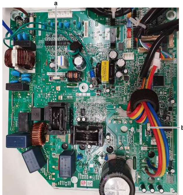
a Fuse F1U b Fuse F2U
